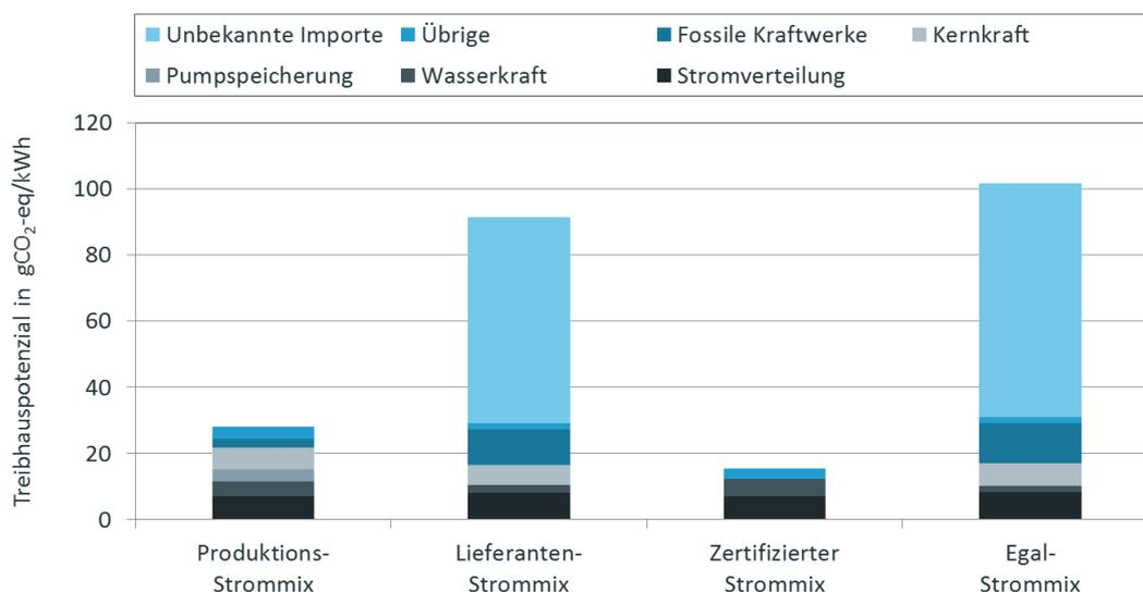
Fig. 5.1 Klimaänderungspotenzial der Schweizer Strommixe in gCO<sub>2</sub>-eq pro kWh Strom aufgeteilt nach den verschiedenen Technologien der Stromerzeugung und der Stromverteilung. Die unbekannt Importe werden mit dem ENTSO-E Strommix modelliert. Die Zahlen und Anteile zu den Treibhausgasemissionen sind in Tab. A.1 und Tab. A.2 im Anhang aufgeführt.
