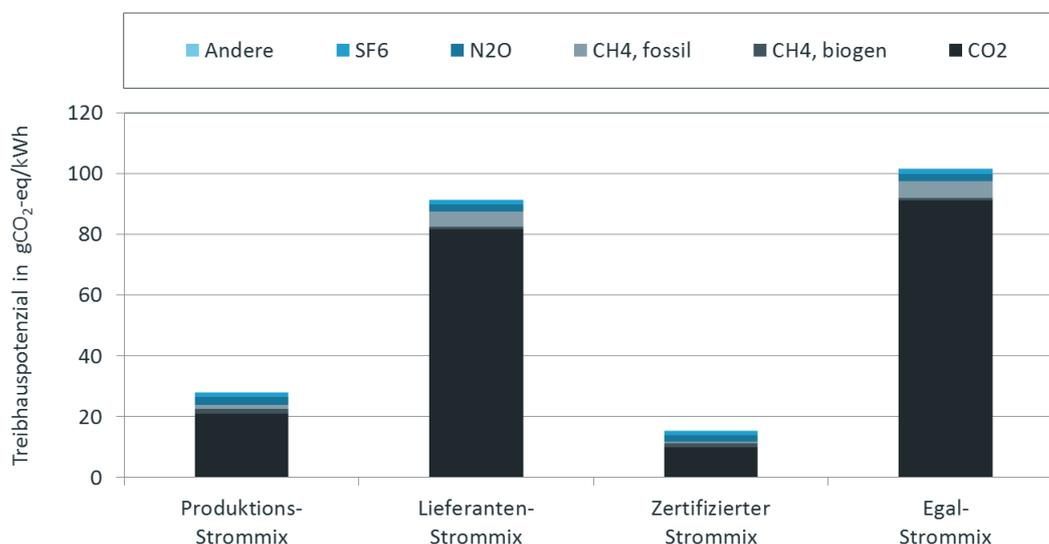
Fig. 5.2 Klimaänderungspotential der Schweizer Strommixe in gCO<sub>2</sub>-eq pro kWh Strom aufgeteilt nach Treibhausgasen. Die Zahlen zu den Treibhausgasemissionen nach Substanz sind in Tab. A.3 im Anhang aufgeführt.
