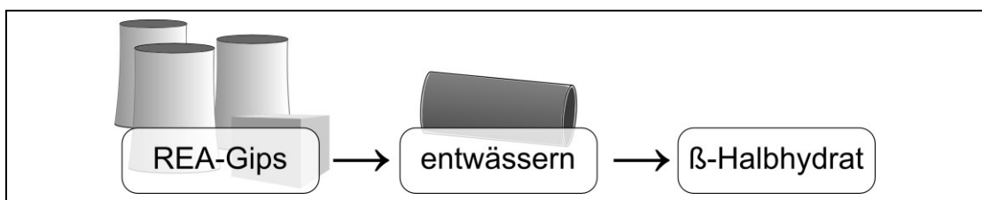
Abbildung 2: Produktion Stuckgips ( \beta -Halbhydrat) aus REA-Gips
