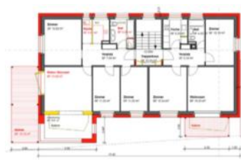
Abb. A. 23 Grundriss Regelgeschoss
